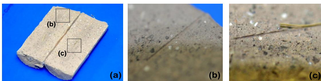
Figura 4-11 – (a) Provete de ensaio de arrancamento de fibra tratada rompido longitudinalmente; (b) Impressão da fibra na matriz; (c) Rotura da fibra durante ensaio de arrancamento
