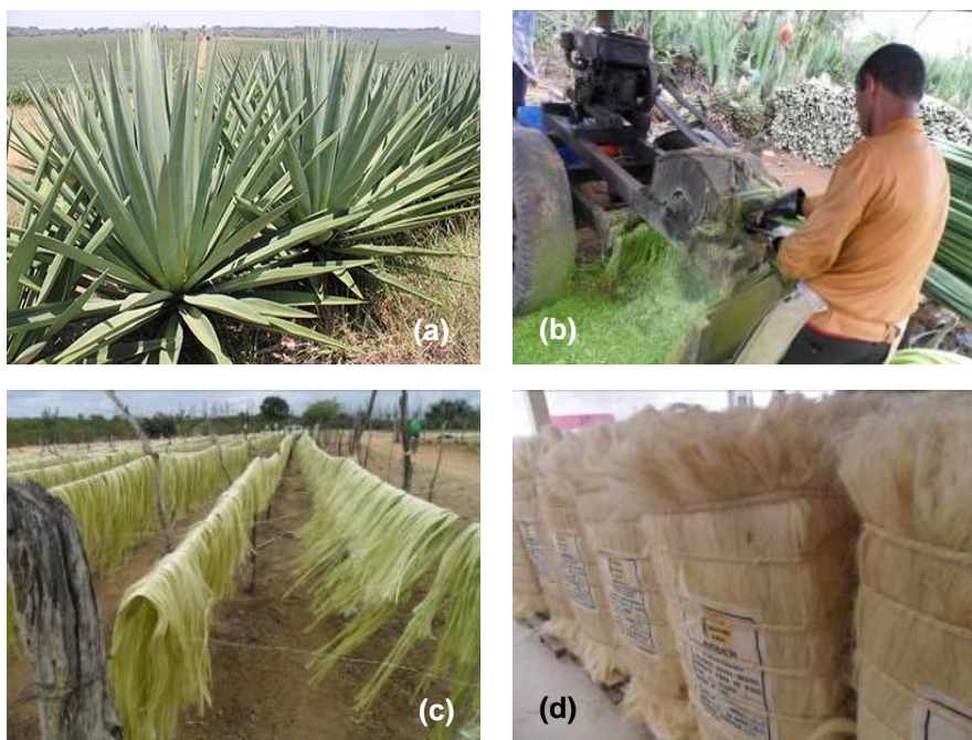
Figura 2-2 - Extração das fibras longas de sisal: (a) planta agave sisalana; (b) desfibrilamento mecânico; (c) secagem; (d) enfardamento para venda (Ferreira, 2012)
