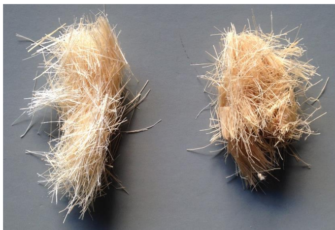
Figura 4-1 - Alteração na coloração das fibras sem tratamento (esquerda) e após 10 ciclos de molhagem e secagem (direita)
