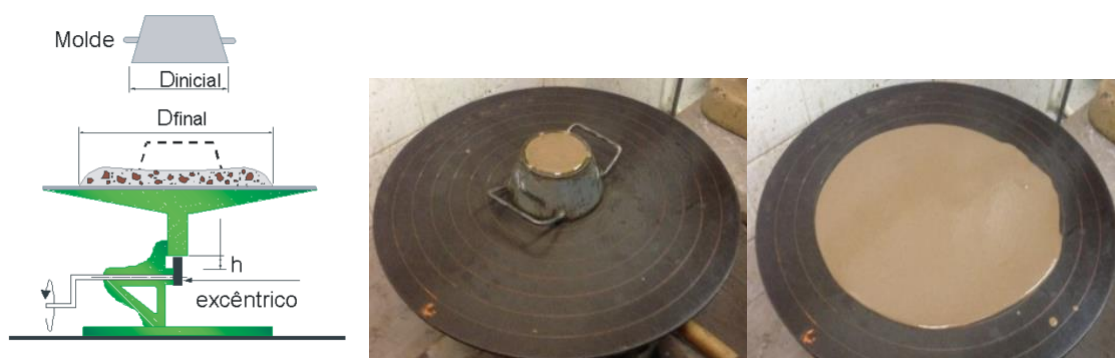
Figura 3-17 – Representação esquemática do ensaio de consistência padrão para avaliação da trabalhabilidade da matriz e respectivo resultado
