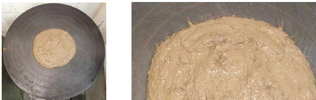
Figura 3-19 - Homogeneização e dispersão das fibras
