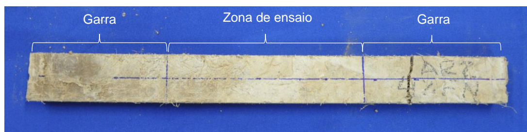
Figura 4-19 - Modo de rotura de provete ensaiado à tracção
